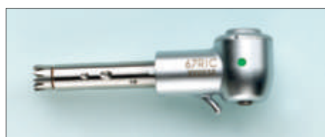
Kirurgihuvud 67 RIC Kirurgihuvud förstärkt för vinkelstycksborr. Lättmanövrerad tryckknappschuck. Sprayanslutning för extern kylning genom fast monterat sprayrör samt genom intern borkkylning enligt Kirschner & Meyer. Nedväxlat 4:1 Roterande
